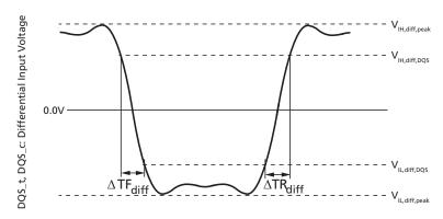
Table 108: DDR4-1600 through DDR4-2400 Differential Input Slew Rate and Input Levels for DQS\_t, DQS\_c
