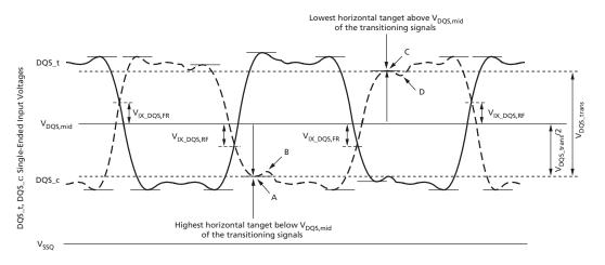
**Table 106: Cross Point Voltage For Differential Input Signals DQS**
