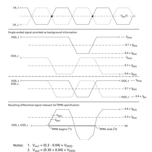
3. DQS\_t and DQS\_c low level =  $V_{DDQ}/(50 + 34) \times 34 = 0.4 \times V_{DDQ}$
