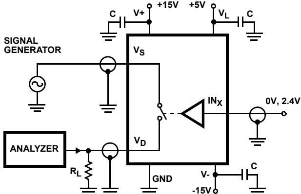
FIGURE 4. OFF ISOLATION TEST CIRCUIT
