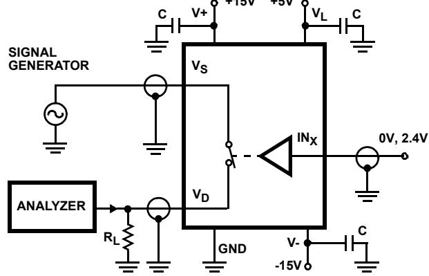
FIGURE 5. INSERTION LOSS TEST CIRCUIT
