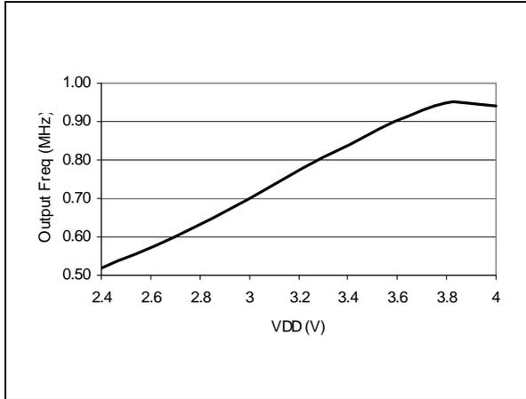
Figure 53. RC Osc Freq vs  $V_{DD}$
