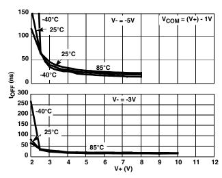
FIGURE 16. TURN - OFF TIME vs POSITIVE SUPPLY VOLTAGE
