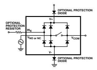
FIGURE 8. OVERVOLTAGE PROTECTION
