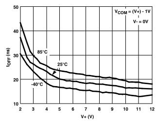
FIGURE 14. TURN - OFF TIME vs POSITIVE SUPPLY VOLTAGE
