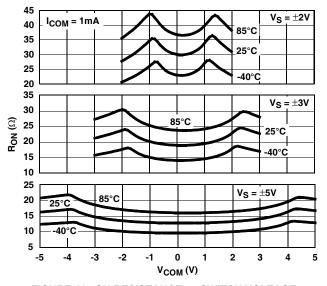
FIGURE 11. ON RESISTANCE vs SWITCH VOLTAGE
