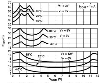
FIGURE 10. ON RESISTANCE vs SWITCH VOLTAGE
