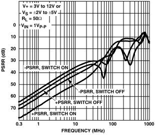
FIGURE 21. ±PSRR vs FREQUENCY
