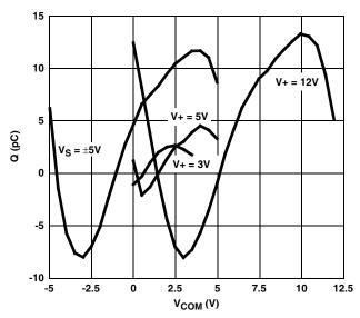
FIGURE 12. CHARGE INJECTION vs SWITCH VOLTAGE
