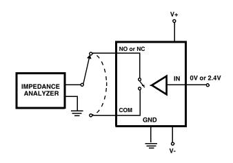
FIGURE 7. CAPACITANCE TEST CIRCUIT
