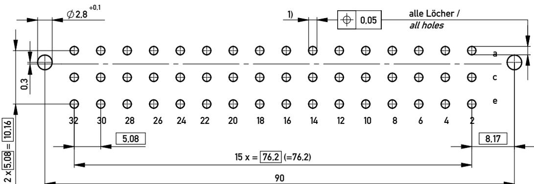
Elastische Einpresszone / compliant pressfit zone
