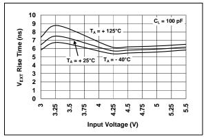
**FIGURE 2-7:** V<sub>EXT</sub> Rise Time vs. Input Voltage.
