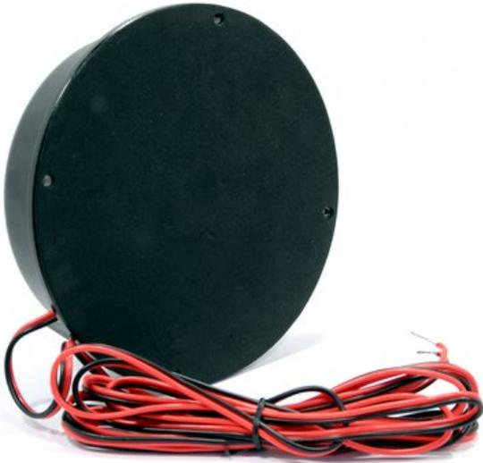
**Körperschallwandler** für die Basswiedergabe. Die Montage erfolgt auf einer schwingfähigen Fläche, die dadurch direkt zum Schwingen angeregt wird (z.B. Karosserieblech im Auto, Untergestell eines Sofas o.ä.). Ein geschlossenes Gehäuse ist nicht notwendig. Mit dem BSX 130 WP - 4 Ohm können so die untersten Bassanteile z.B. bei der Filmwiedergabe körperlich spürbar gemacht werden.
