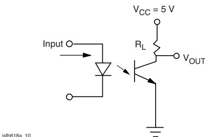
**Fig. 2 - Test Circuit**
