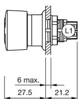
L1 = Löt-/Steckanschluss 2.8 x 0.5 mm
