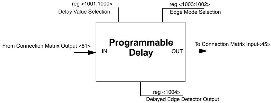
Figure 28. Programmable Delay
