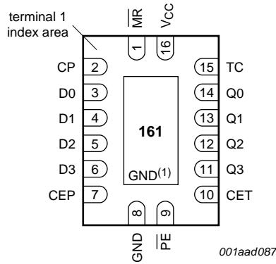
Fig 6. Pin configuration for DHVQFN16
