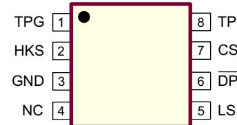
8-Lead SOIC (Narrow Body) (LG)
