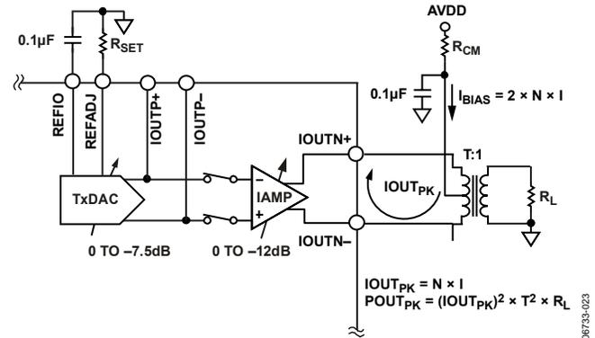
Figure 23. Current-Mode Operation
