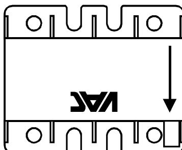
Optimale Position des Rückleiters für kurze Ansprechzeiten ist eine seitliche Rückführung des Primärleiters in Höhe des Innenlochs.
