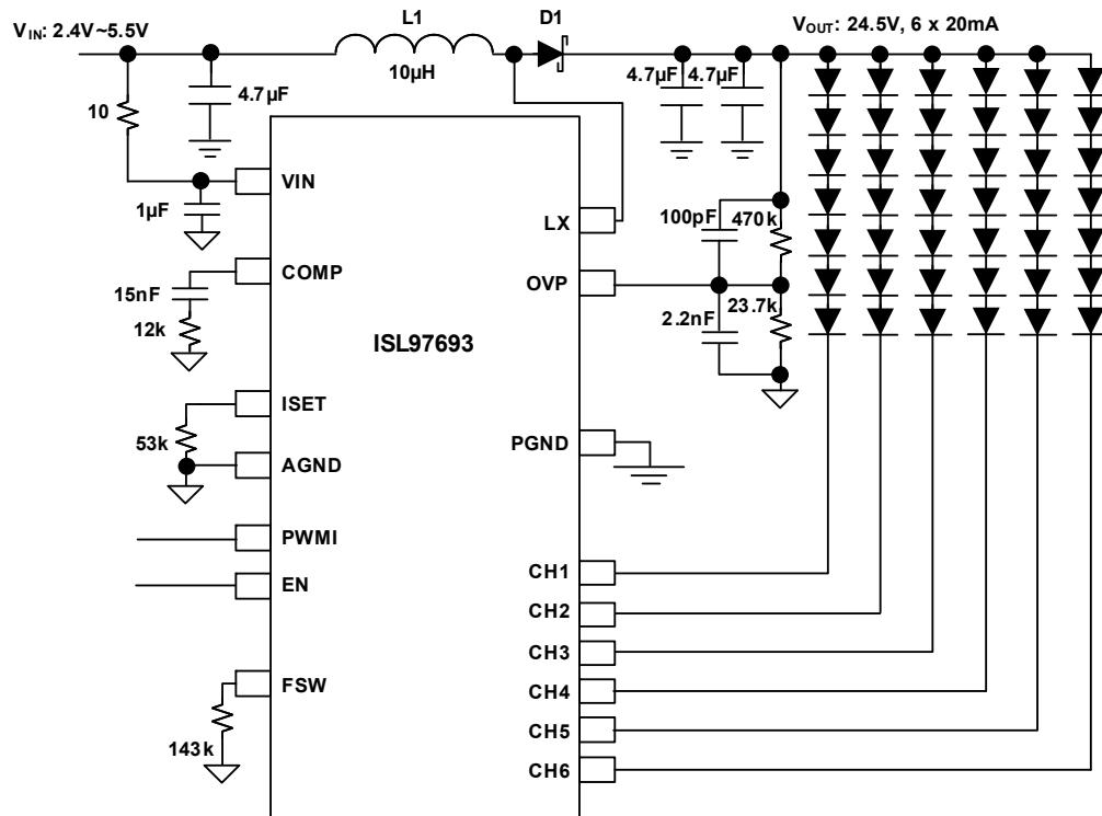
FIGURE 4. ISL97693 TYPICAL APPLICATION DIAGRAM - 6P7S
