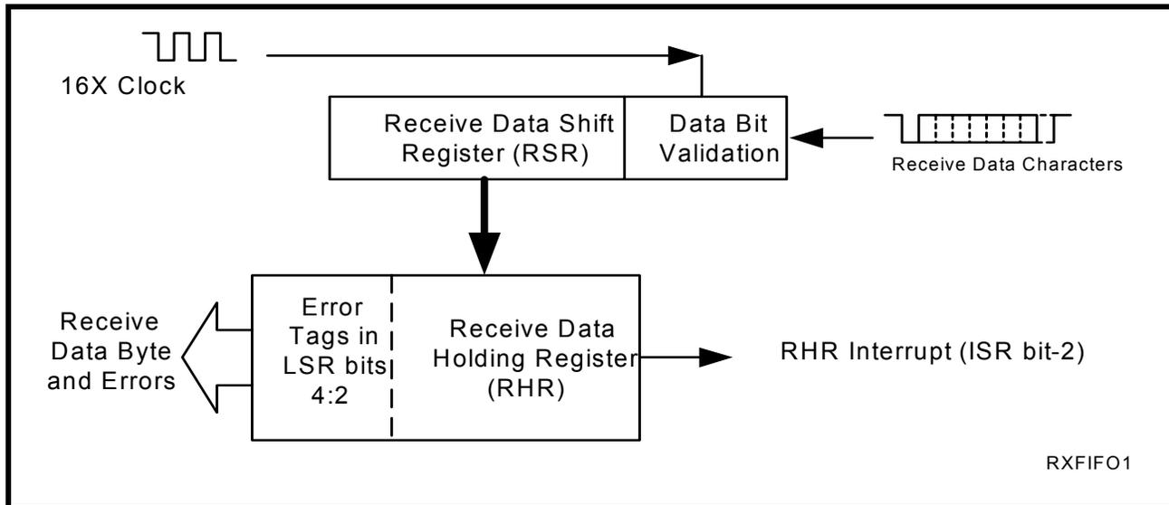
FIGURE 8. RECEIVER OPERATION IN FIFO AND AUTO RTS FLOW CONTROL MODE
