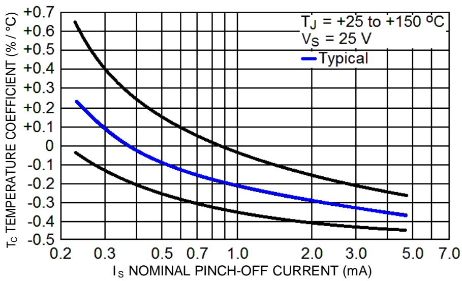
**FIGURE 2 – TEMPERATURE COEFFICIENT**
