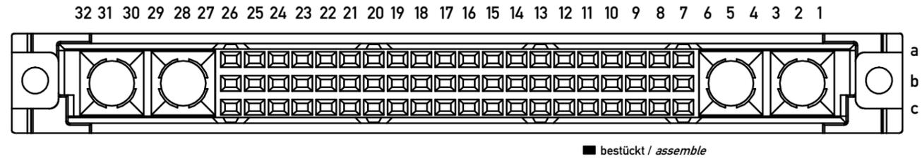
Tauchlötanschluß 0,65x0,3mm / solder terminal 0,65x0,3mm
