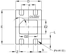
X1-DFN1216-4 Dim Min Max Α 0.47 0.53 0.50 **A1** 0.00 0.05 0.02 **A3** b 0.15 0.25 0.20 D 1.15 1.25 D2 0.75 0.95 Ε 1.65 E2 0.55 0.75 0.65 е 0.65 L 0.20 0.30 0.25 Z 0.175 All Dimensions in mm
