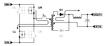
FIGURE 16. UR TO LL POWER TRANSFER CYCLE
