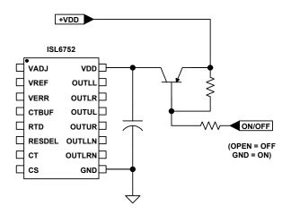
FIGURE 22. ON/OFF CONTROL USING VDD
