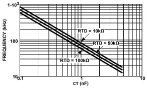
FIGURE 7. CAPACITANCE vs FREQUENCY
