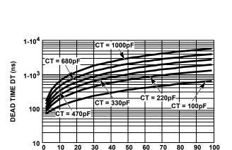
RTD (kΩ) FIGURE 6. DEAD TIME (DT) vs CAPACITANCE
