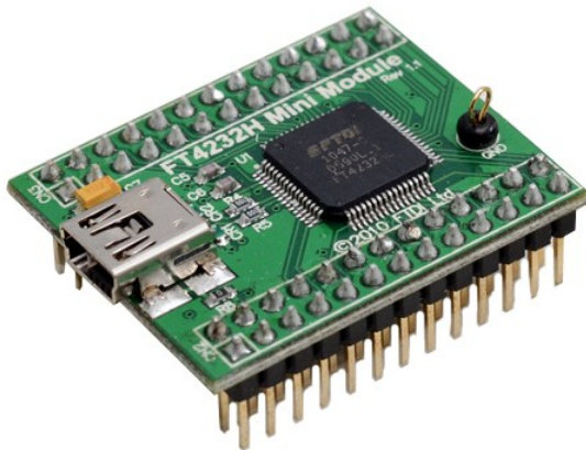
Figure 1.1 - FT4232H Mini Module
