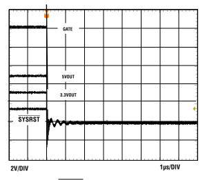
FIGURE 5. SYSRST LOW TO OUTPUT LATCH-OFF
