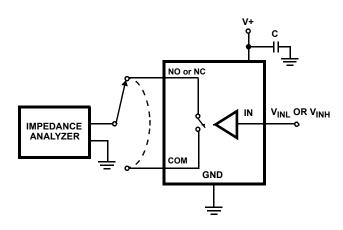
FIGURE 7. CAPACITANCE TEST CIRCUIT
