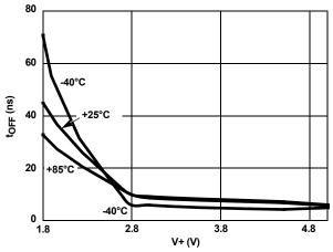
FIGURE 14. TURN-OFF TIME vs SUPPLY VOLTAGE
