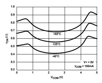
FIGURE 10. ON-RESISTANCE vs SWITCH VOLTAGE
