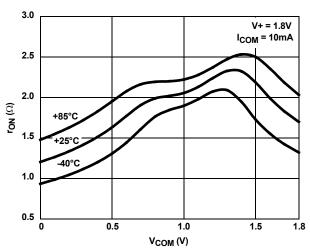
FIGURE 12. ON-RESISTANCE vs SWITCH VOLTAGE
