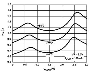
FIGURE 11. ON-RESISTANCE vs SWITCH VOLTAGE
