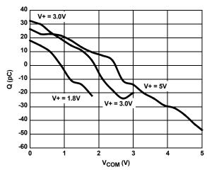
FIGURE 18. CHARGE INJECTION vs SWITCH VOLTAGE
