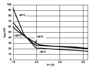
FIGURE 13. TURN-ON TIME vs SUPPLY VOLTAGE
