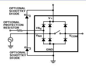
FIGURE 8. OVERVOLTAGE PROTECTION
