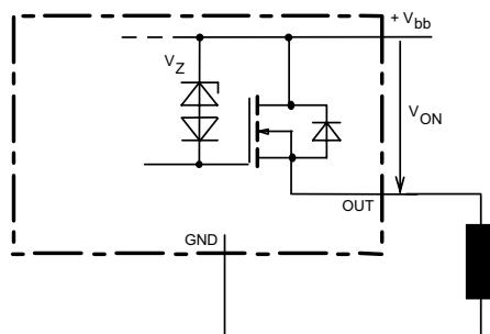
$V_{ON}$  clamped to 59V min.
