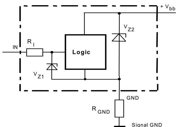
$V_{Z1}=6.1\text{V typ.}$ ,  $V_{Z2}=V_{bb(AZ)}=62\text{V min.}$ ,
