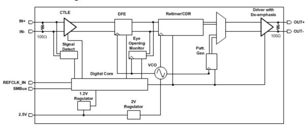
Figure 3. DS125DF410 Data Path Block Diagram — One of Four Channels
