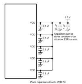
Figure 11. Example Power Connections Diagram for the DS125DF410
