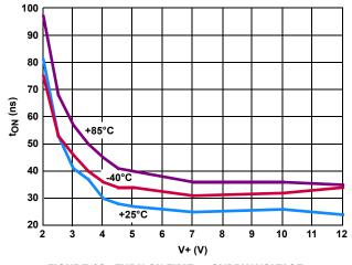
FIGURE 13. TURN-ON TIME vs SUPPLY VOLTAGE
