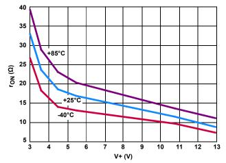
FIGURE 9. ON-RESISTANCE vs SUPPLY VOLTAGE
