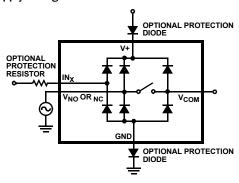
FIGURE 8. OVERVOLTAGE PROTECTION
