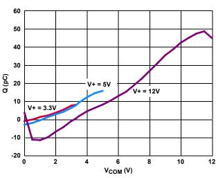
FIGURE 12. CHARGE INJECTION vs SWITCH VOLTAGE
