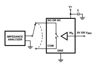
FIGURE 7. CAPACITANCE TEST CIRCUIT
