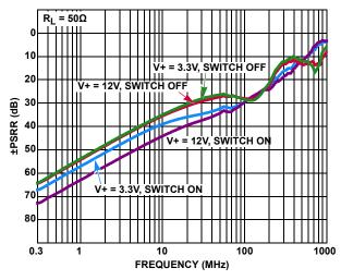
FIGURE 18. ±PSRR vs FREQUENCY
