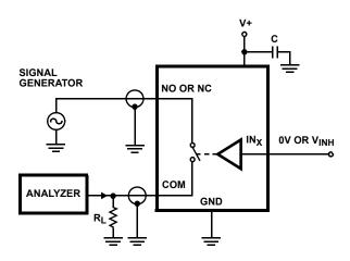
FIGURE 4. OFF ISOLATION TEST CIRCUIT
