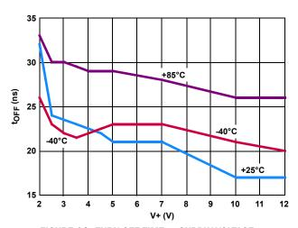
FIGURE 14. TURN-OFF TIME vs SUPPLY VOLTAGE
