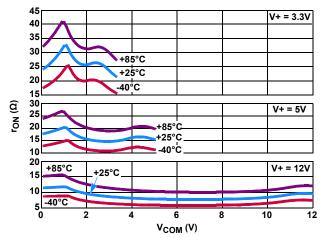
FIGURE 10. ON-RESISTANCE vs SWITCH VOLTAGE
