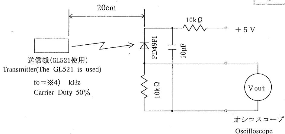
この図において、出力  $V_{out}(p-p)$  が 40mV になる様に設定された送信機とする。但し、ここで使用する PD49PI は、
