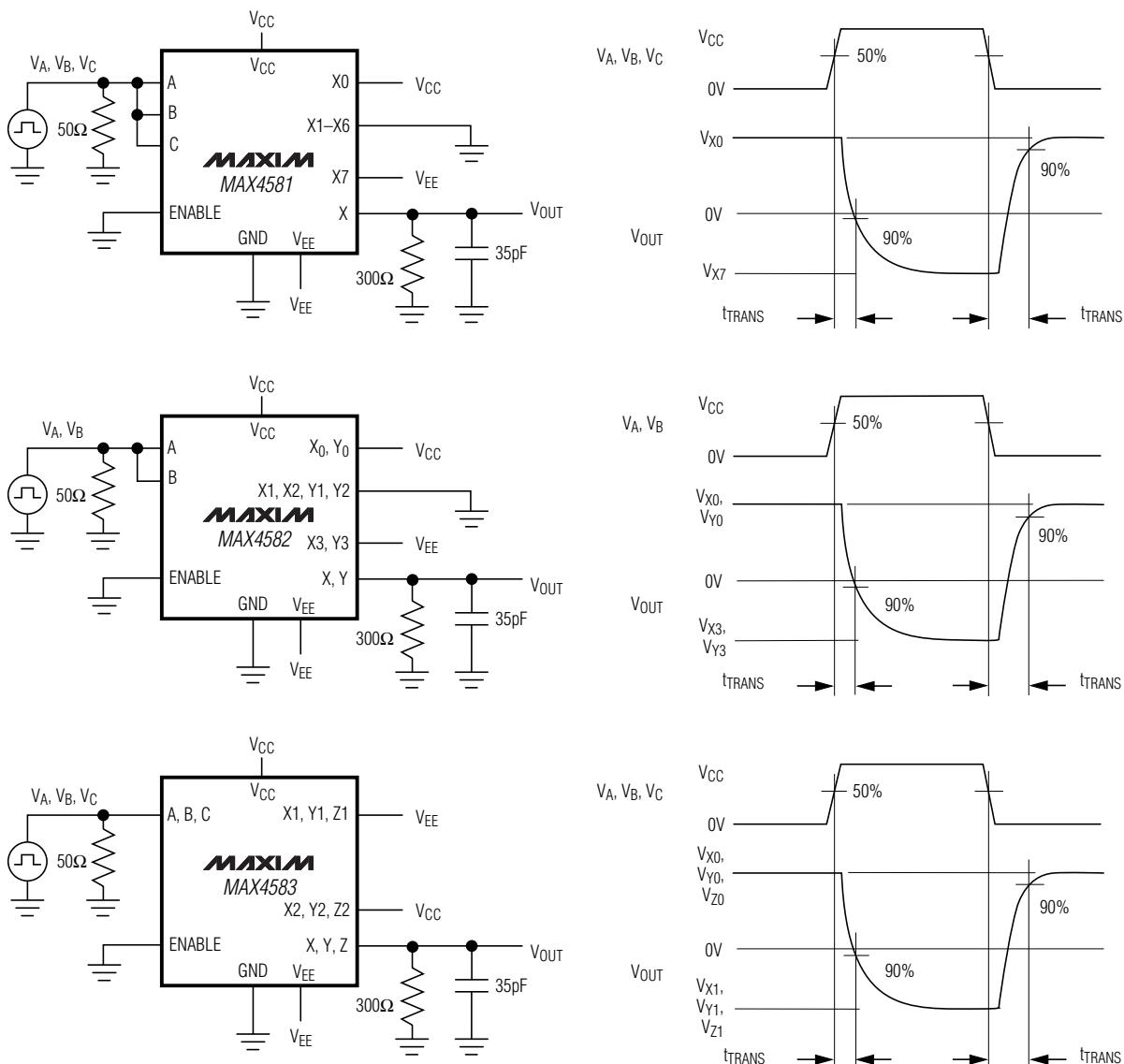
V<sub>EE</sub> = 0V FOR SINGLE-SUPPLY OPERATION.
