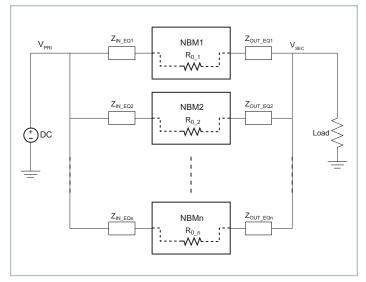
Figure 22 — NBM module array
