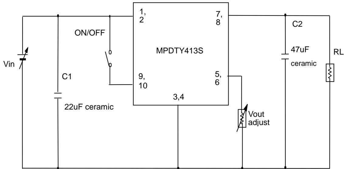
C1 :  $22\mu\text{F}/25\text{V}$  Ceramic Capacitor
