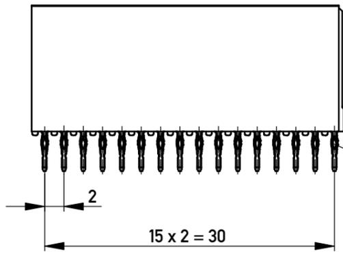
EN Zone für durchkontaktierte Löcher  $\phi 0,6 \pm 0,05$
