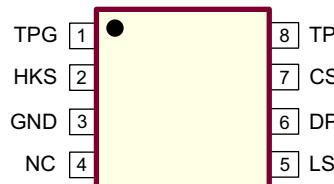
8-Lead SOIC (Narrow Body) (LG)
