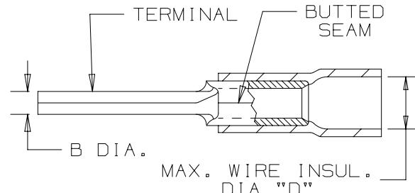
\* EV10-P55 NOT UL LISTED, BRAZED SEAM, 300V MAX VOLTAGE
