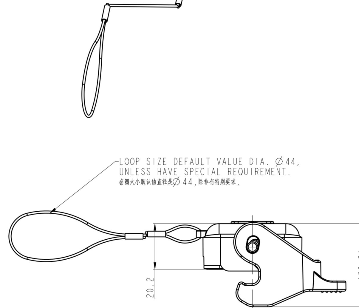
T1010241500-000 H24B-KDTP-LB H24B HOOD PLASTIC PROTECTION COVER, PLASTIC SINGLE LOCKING, SEALING, NYLON ROPE, GREY H24B上壳塑料保护盖, 塑料单扣, 带密封, 尼龙绳, 灰色
