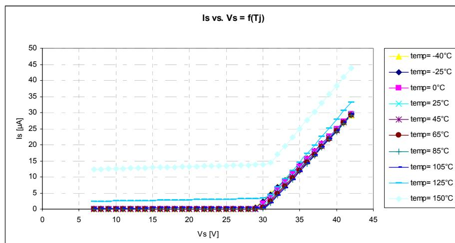
**Figure 15**  $I_s$  vs  $V_s$  =f( $T_j$ )
