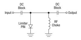
**Figure 2. Single-Stage Limiter Circuit**
