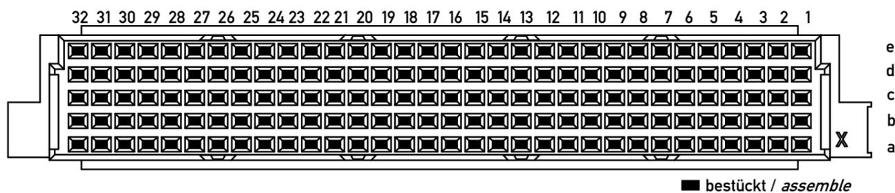
Tauchlötanschluß 0,7x0,3mm / solder terminal 0,7x0,3mm
