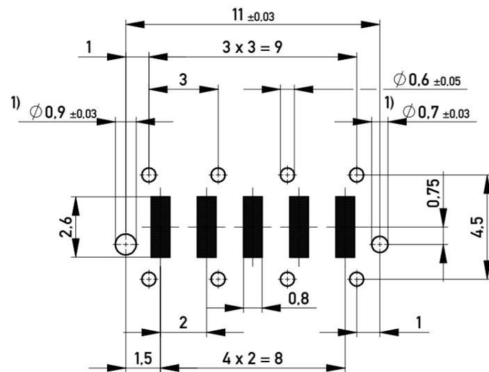
1) Durchmesser des Bohrers / Drill tool
