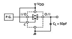
2. t<sub>pZL</sub>, t<sub>pZH</sub>, t<sub>pLZ</sub>, t<sub>pHZ</sub> Control-O/I
