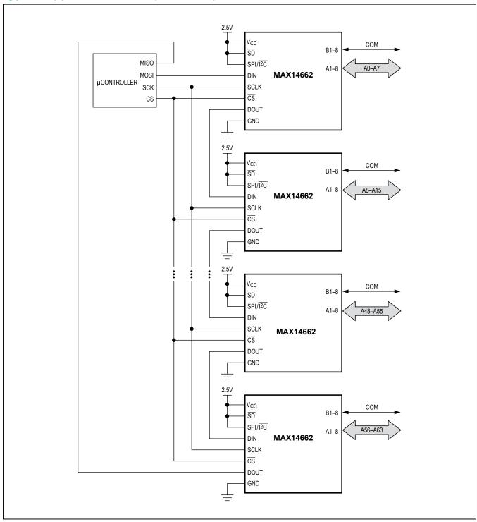
Figure 15. SPI Daisy Chain 64:1 MUX
