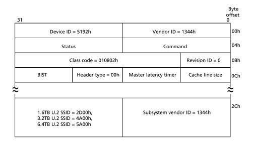
Figure 3: 9200 PRO PCIe Header
