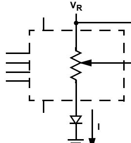
TWO-TERMINAL VARIABLE RESISTOR;
