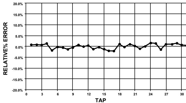
FIGURE 6. TYPICAL RELATIVE% ERROR PER TAP POSITION
