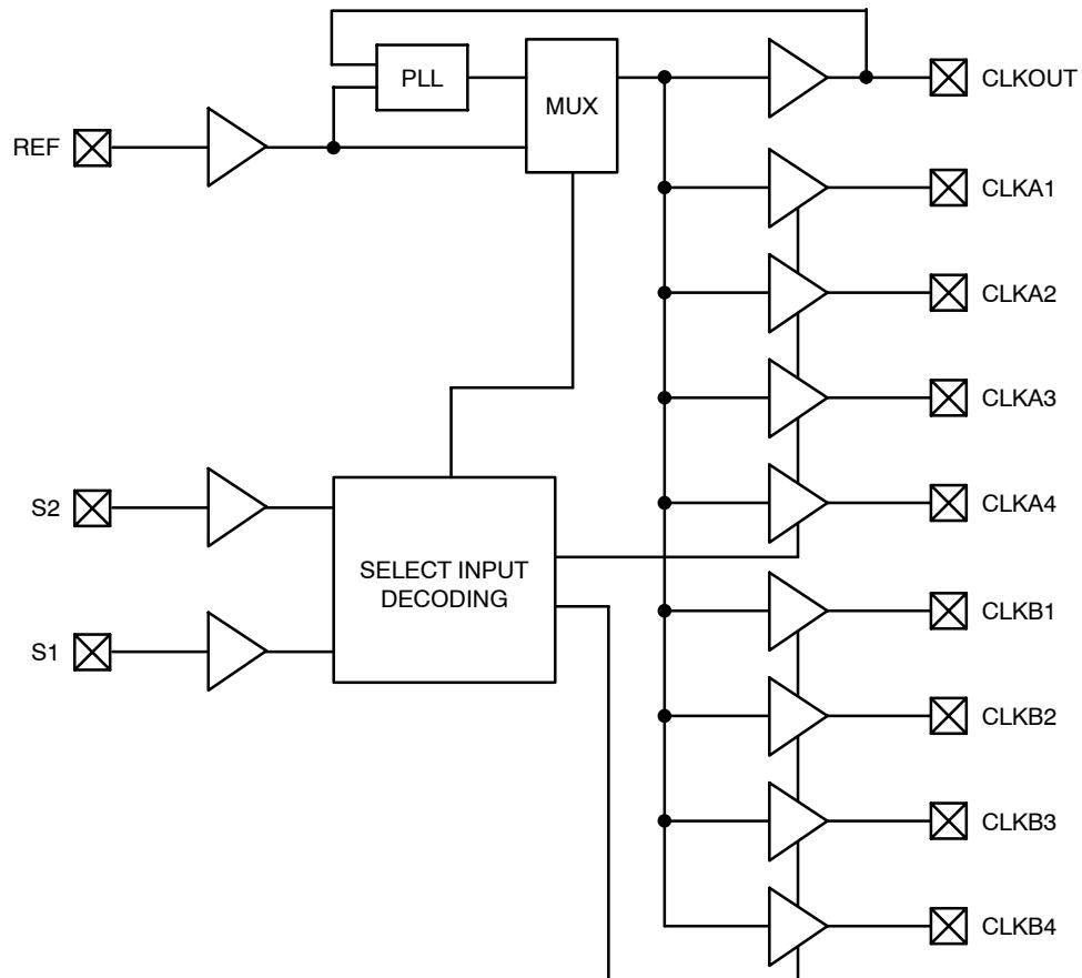
**Figure 1. Block Diagram**
