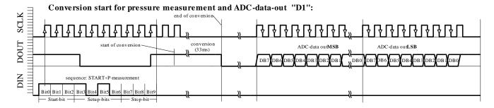
Fig. 6a: D1 ACQUISITION sequence
