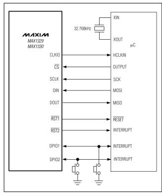
Figure 26. Digital-Interface Connections
